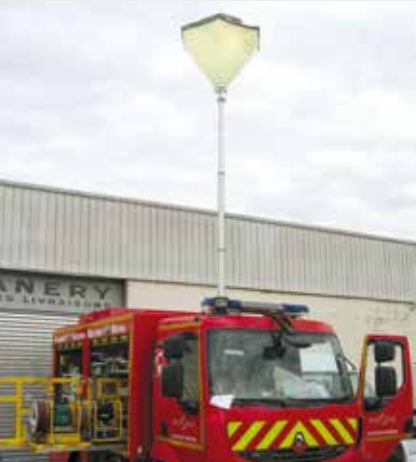
LUMICONE EXTENDED LUMICONE AUSGEFAHREN
